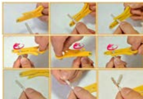
شکل ۷- روکش برداری کابل
