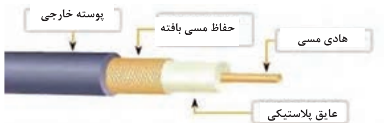
شکل ۳- اجزای کابل کوکسیال
