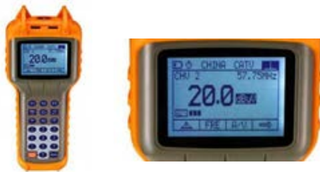
شکل ۲۴- اندازه‌گیری سیگنال خروجی آنتن توسط سیگنال سنج
